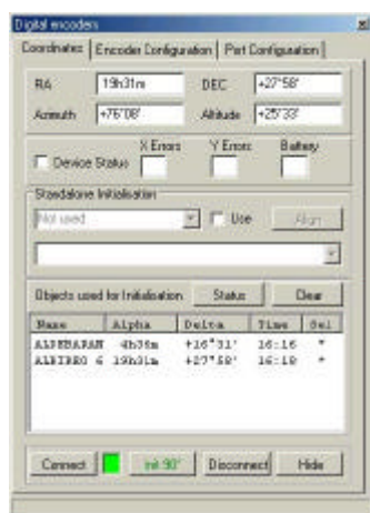
Fig. 13 Fenêtre Digitaux encodeurs pour l'initialisation des codeurs de la position de télescope astronomique.
