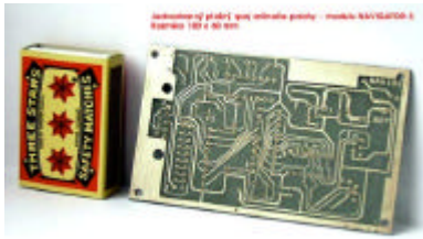
Fig. 9. (jpg) Vue sur le CI unilatéral 100x60 mm pour le module NAVIGATOR-1
