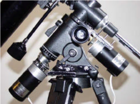
Fig. 1. (jpg) Vue générale sur la monture équatoriale GS-300 avec les codeurs IRC 122
